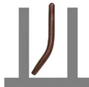
Применение изогнутой контактной трубки
