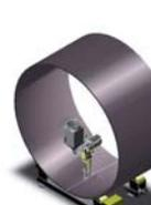
Внутренняя продольная дуговая сварка под флюсом с использованием системы колонны со стрелой
