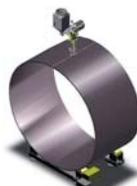
Наружная сварка продольного шва под флюсом с использованием системы колонны со стрелой
