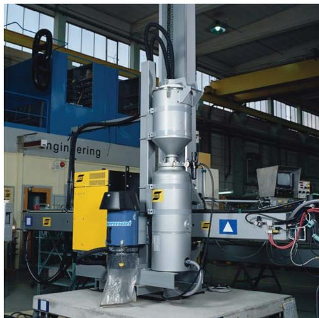
Системы FFRS 2000/3000 состоят из следующих элементов: шланг подачи сжатого воздуха 25 м 1/2", шланг подачи флюса из TCP в бункер 25 м (20 м для систем с нагревом), всасывающий шланг для флюса 16 м, всасывающий шланг между первичным сепаратором и вакуумной установкой (1200 = 2 м, 3000 = 5 м), изогнутый впускной патрубок для флюсового бункера и сопла подбора флюса.
