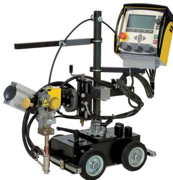
A2 Multitrac для сварки в защитных газах
